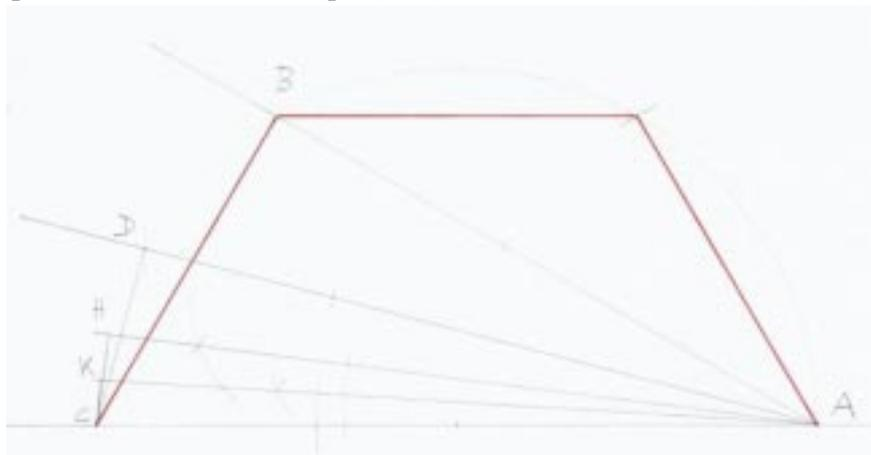
On désigne alors par  $b_n$  le demi côté du polygone régulier, circonscrit au cercle, de  $n$  côtés. Alors  $CB = b_6$ ,  $CD = b_{12}$ ,  $CH = b_{24}$ ,  $CK = b_{48}$ ,  $CL = b_{96}$
